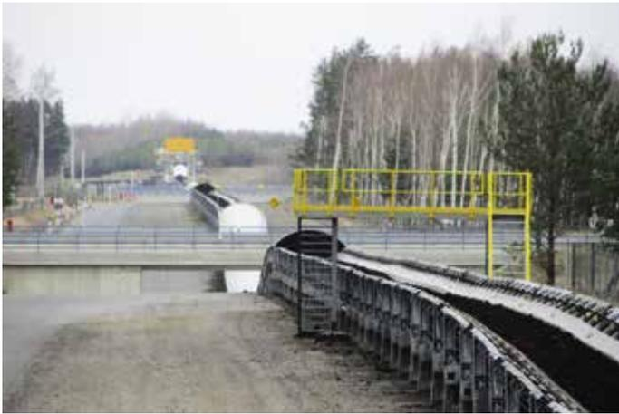
Abb. 2: Fernbandanlage für Braunkohle in einem Tagebau mit einer Länge von 16 km und modernen Kamera-Überwachungssystemen mit Aufschaltung der Signale in der Leitstelle der Werkfeuerwehr
