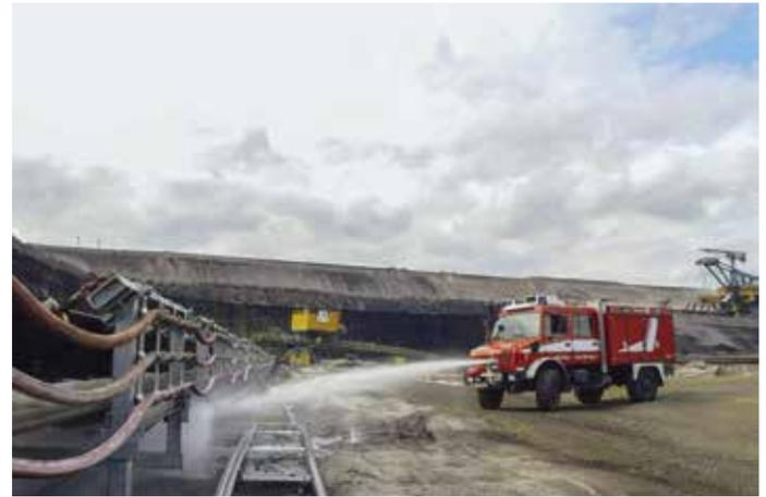
Abb. 3: Ein speziell konzipiertes Vorauslöschfahrzeug des MLT im Einsatz mit dem Frontmonitor zur Erstbrandbekämpfung an einer Bandanlage
