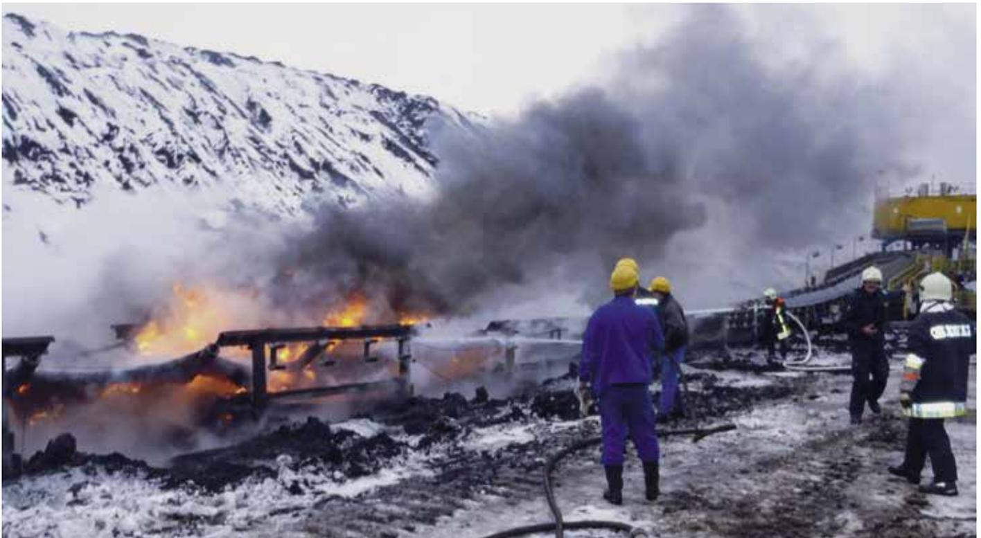
Abb. 1: Brand an einer Gurtbandanlage im Tagebau bei winterlichen Temperaturen von  $-7^{\circ}\text{C}$ . Die Bandanlage wurde betriebsbedingt angehalten und das Band durch eine heiß gelaufene Tragrolle entzündet. Nur 15 Minuten vor Ausbruch des Brandes hatte ein Bandkontrolltrupp die Bandanlage inspiziert und keinen Brand festgestellt.
