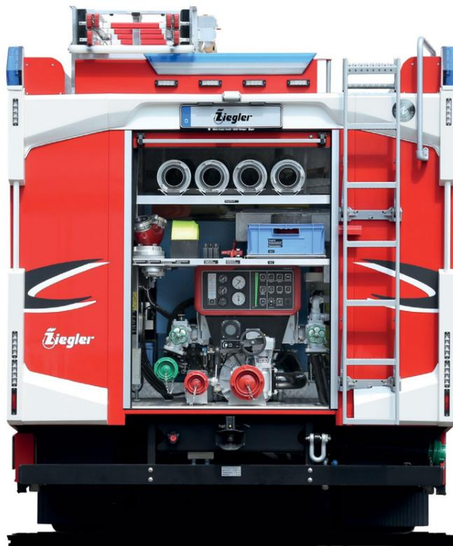
Auch für den Querverkehr deutlich sichtbar: Das flache Top-Integro-Line-Blaulicht mit weit auf die Fahrzeugseite gezogenen LED-Kennleuchten.
