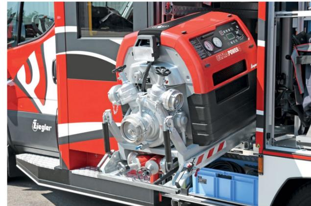
Der Schwerlastauszug für die Tragkraftspritze ist absenkbar. Durch die Schrägstellung kann das Gerät schnell, ergonomisch schonend und ungehindert entnommen werden.
