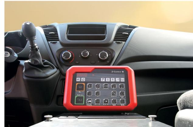
Maschinist und Gruppenführer können alle wichtigen Funktionen über das drehbar am Armaturenbrett angeordnete Z-Control-Bedientableau überblicken und steuern. Die ergonomisch konzipierten Bedienelemente sind klar und übersichtlich gestaltet.
