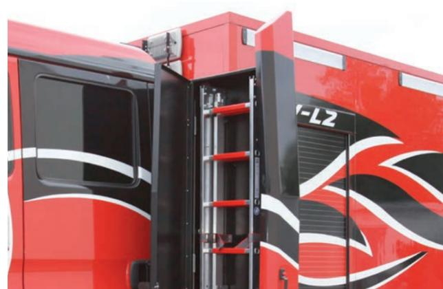
Der ausziehbare Geräteträger ermöglicht die ergonomische, sichere Entnahme von schweren und sperrigen Ausrüstungen.
