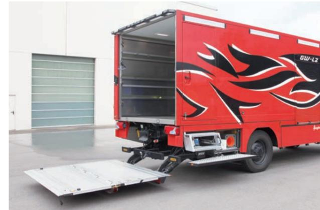
Mit wenigen Handgriffen und in Sekundenschnelle kann ein rutschfester Auftritt zur hinteren Seitentüre geschaffen werden. Dadurch ist ein rasches, sicheres Betreten der Ladefläche möglich.
