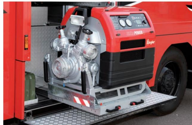
Auf stabilen Schwerlastauszügen gelagert, kann die Tragkraftspritze PFPN 10-1000 so weit ausgezogen werden, dass sie in ergonomischer Position entnommen werden kann.
