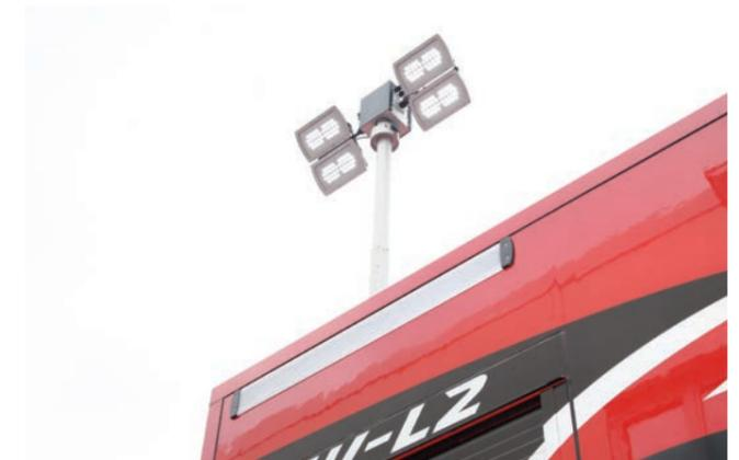
Zur großzügigen Einsatzstellenbeleuchtung dient auch der zwischen Kabine und Aufbau positionierte, pneumatisch ausfahrbare Lichtmast. Die schwenk- und drehbaren LED-Strahler können über eine Fernbedienung gesteuert werden.
