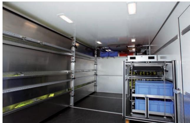
Der große Aufbau bietet im Innenraum Platz für bis zu 9 Rollcontainer. Über Sicherungsleisten sind sie schnell zu verzurren und optimal zu transportieren. Die im Aufbaudach eingelassenen LED-Leuchtmodule können bei Bedarf auf rotes oder grünes Licht umgeschaltet werden.
