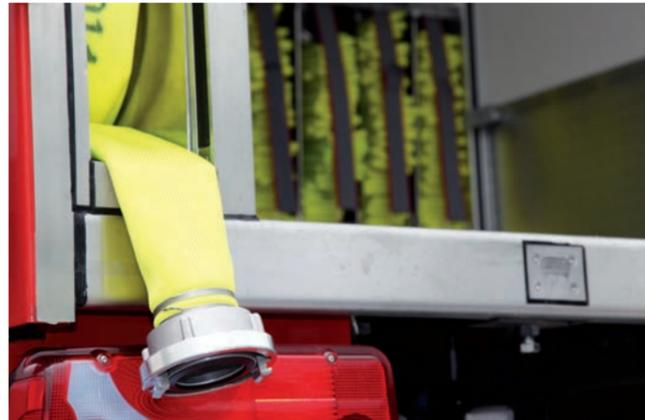
Das schnelle, sichere Verlegen von gekuppelten B-Schläuchen ist auch bei geschlossener Ladebordwand sichergestellt. Aufklappbare Seitenfächer sichern die auf vier Ebenen gelagerten Schläuche und ermöglichen eine schnelle Neubestückung.
