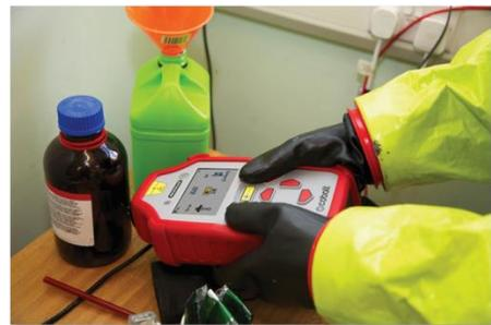
Das **Resolve™-Raman-Gerät** stellt die weitest entwickelte Form der Raman-Spektroskopie kombiniert mit der proprietären SORS™-Technologie (Spatially Offset Raman Spectroscopy) dar.
