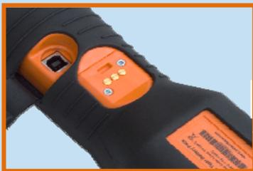
Über die integrierte USB-Schnittstelle kann der PHOCHECK TIGER direkt Daten auf Ihren PC übertragen. Einfach mit einem handelsüblichen USB-Kabel.
