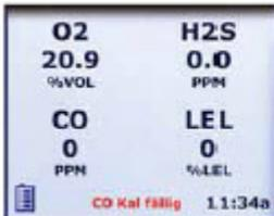
„**Kalibrierung fällig**“ – diese Meldung wird für jeden relevanten Sensor angezeigt.
