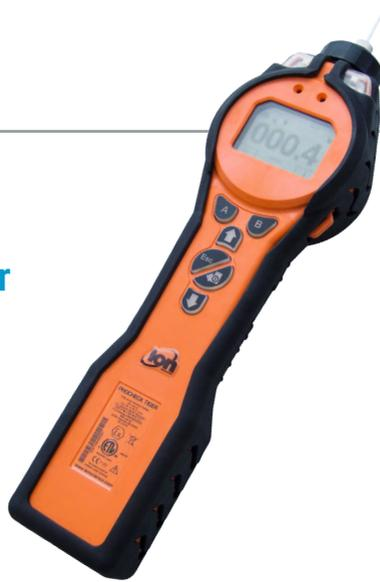
Revolutionär: Das PID Gasmessgerät PhoCheck Tiger für die Messung flüchtiger organischer Verbindungen (VOC) setzt völlig neue Maßstäbe: Mit 1 ppb bis 20.000 ppm bietet es den derzeit größten Messbereich am Markt. Und misst über 450 Gase, die komfortabel über die integrierte Bibliothek aufgerufen werden können.
