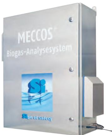
Das MECCOS® Biogas Analysesystem überwacht die Biogasanlage kontinuierlich auf die typischen Gaskomponenten CO<sub>2</sub>, CH<sub>4</sub>, O<sub>2</sub> und H<sub>2</sub>S. Bereits in der Standardausführung ist es mit allen erforderlichen Komponenten für die Messgasaufbereitung wie Messgaskühler mit Kondensatpumpe und Partikelfilter optimal ausgestattet.
