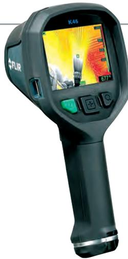
Ideal für den Feuerwehreinsatz bei der Brandbekämpfung und der Personensuche. Konzipiert für härteste Einsatzbedingungen: Die FLIR K45 bzw. K55 ist enorm hitzebeständig, immun gegen Stürze und wasserbeständig gemäß IP67. Auch bei Sichtbehinderung durch starken Rauch liefert der wartungsfreie ungekühlte Mikrobolometer-Detektor durch die FSX™-Technologie detailreiche Bilder und hebt alle wichtigen Struktur- und Texturdetails auf dem Wärmebild hervor.
