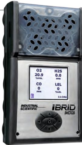
Das MX6 iBrid™ von Industrial Scientific ist das erste tragbare Mehrgasmessgerät mit LCD-Farbdisplay. Die grafische Benutzeroberfläche des Hybridgeräts ermöglicht optimale Lesbarkeit bei allen Lichtverhältnissen. Mit 25 Sensoren lassen sich 6 Gase gleichzeitig messen. Echtzeitwerte in ppm oder Vol% werden deutlich lesbar angezeigt.
