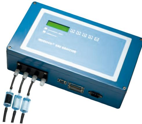
Sorgt für eine Maximierung der Methanausbeute und den optimalen Betrieb einer Biogasanlage: Das stationäre Mehrgasmessgerät MECCOS® Biogas Analysator ermittelt die Hauptbestandteile typischer Biogase. In der Standardausführung werden die Gase Methan, Kohlendioxid und Sauerstoff kontinuierlich überwacht. Optional kann zusätzlich Schwefelwasserstoff gemessen werden.
