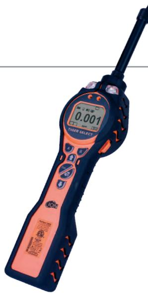
Tiger Select ist ein PID Gasdetektor, geeignet für die selektive Messung von Benzol. Gemäß TRGS 910, Akzeptanzkonzentration 60 ppb – 0,2 mg/m<sup>3</sup> wird ein Benzolvorröhrchen angebracht. Um die gesamte Benzolkonzentration sicher zu erfassen, werden die aktuellen Messwerte während der Messung in Echtzeit angezeigt.
