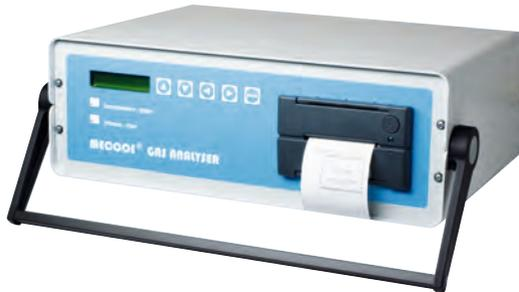
Das tragbare und vielseitig einsetzbare MECCOS® EP3 Infrarot-Spektralphotometer misst infrarot-aktive Gase, wie zum Beispiel Treibhausgas. Durch Auswahl der geeigneten Komponenten können einzelne Gase selektiv oder eine Summe von Gasen gemessen werden. Optional lässt sich das MECCOS® EP3 mit weiteren Messzellen bestücken.
