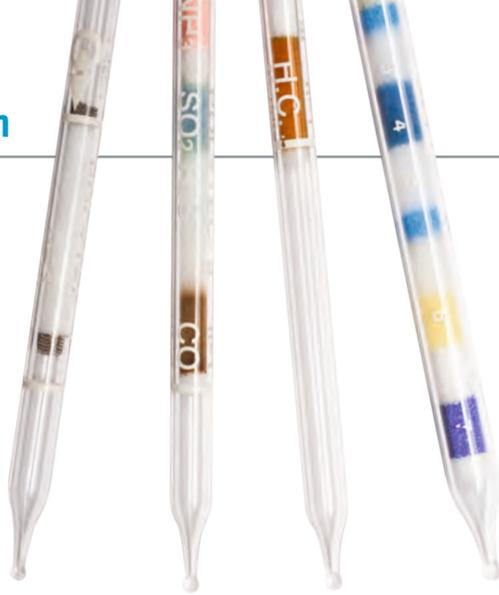
Wenn die Gasgefahr nicht bekannt ist, werden die Mehrgas-Prüfröhrchen vom Typ Polytec eingesetzt. Polytec I bis V zeigen in einem Röhrchen qualitativ und simultan verschiedene Stoffe oder Stoffgruppen an. Aus der Verfärbung ergibt sich die weitere Messstrategie, sei es um mit Gaswarngeräten oder weiteren Prüfröhrchen dem Stoff auf die Spur zu kommen.
