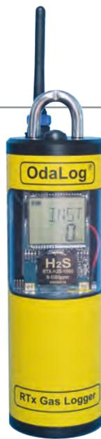
Mit dem OdaLog™ RTx sind ab sofort die gemessenen H<sub>2</sub>S-Messwerte via GSM-Modem in Echtzeit da. Denn die Geruchs- und Korrosionskontrolle basiert stets auf aktuellen Messwerten. Weltweit sind die Messdaten über die proprietäre Software OdaStat-G abrufbar.
