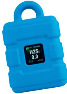
myDatasens BLE Gateway H2S ist ein portables Messgerät im Gummischutzpanzer zum Messen und Übertragen der H2S-Konzentration in der Umgebungsluft mittels Bluetooth Smart (BLE) bzw. BLE und Mobilfunk (3G) optional selbst in der ATEX Zone 1. Als kontinuierlicher Datenlogger hilft er dabei, Schäden frühzeitig zu erkennen, Ausfälle zu vermeiden und Prozesse zu optimieren.
