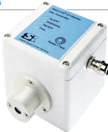
MECCOS® iTR / eTR sind stationäre Stand-Alone Transmitter. iTR-Transmitter arbeiten mit Infrarotmesszellen für CO<sub>2</sub>, CH<sub>4</sub>. eTR-Transmitter arbeiten mit elektrochemischen Messzellen für toxische Gase und Sauerstoff.
