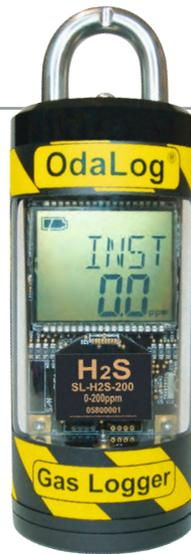
Extrem leistungsstark: Der Datenlogger OdaLog™ L2 wurde speziell für die Abwasserindustrie zur kontinuierlichen Langzeitaufzeichnung von H<sub>2</sub>S-Konzentrationen entwickelt. Die Speicherkapazität des tragbaren Messgeräts umfasst 42.000 Messwerte. Mit seinem leistungsstarken Sensor kann der OdaLog™ L2 bis zu vier Wochen lang konstant im Einsatz bleiben.
