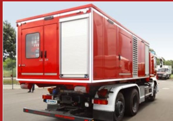
Besonders flache Bauweise mit 2 m Containerhöhe und Schaltschrank am Heck.
