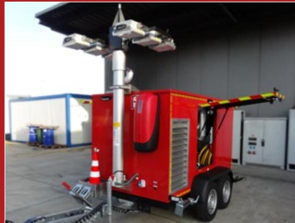
9m Lichtmast an der Front mit DIN-Zapfen auf Lichtkreuz, Fremdeinspeisung, Kegel und Feuerlöscher an der Front.
