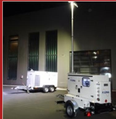
Hervorragende Ausleuchtung schon mit einem 6m Mast und knapp 100.000 lm
