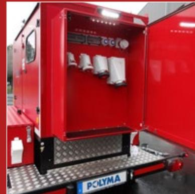
Abschließbares Steckdosenfeld mit Bodendurchführung, und automatischer LED-Beleuchtung
