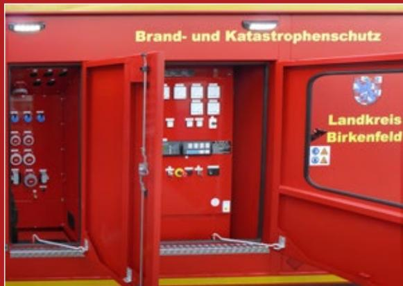
Schaltanlage und Abgangsfeld schalltechnisch separiert. Kabeldurchführung im Boden zur Sicherung gegen Unbefugte.
