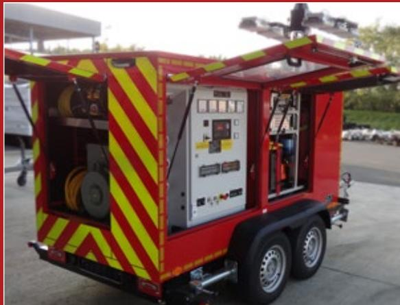
Übersichtliches Bedientableau Abgangsfeld mit Kabeldurchführung im Grundrahmen, Platz für Zubehör in Regal aus Aluminium-Profilen und im Heck, individuelles Beklebungskonzept
