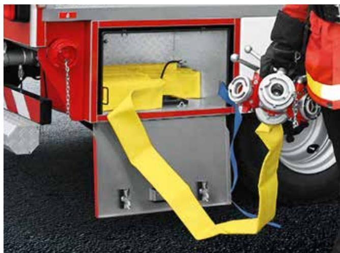
/ Alles ist einsatztaktisch optimal gelagert – hier z. B. ein Verteilerschnellangriff mit B20-Schlauch.
