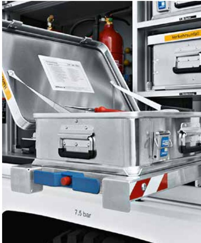
/ Mehr Platz, weniger Zeitverlust: Der Auszug ist so weit herausziehbar, dass die Werkzeugbox zum Öffnen nicht entnommen und nicht am Boden abgestellt werden muss. (Option)
