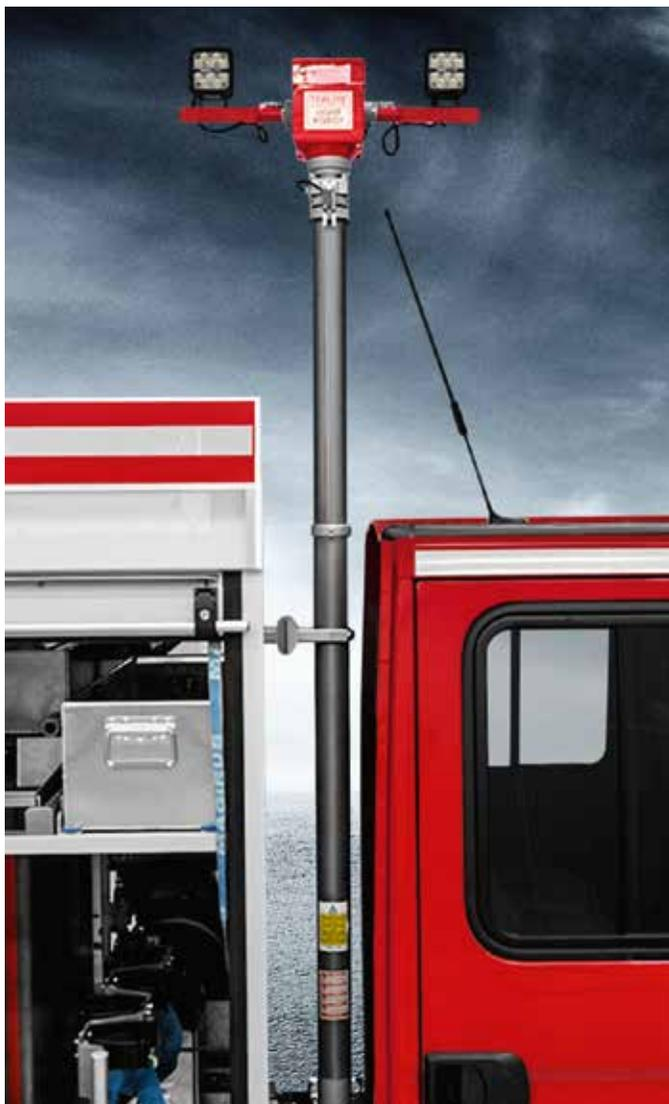
/ Mit einem zwischen Kabine und Aufbau montierten, teleskopierbaren Lichtmast (Option) kann die Einsatzstelle großflächig ausgeleuchtet werden.
