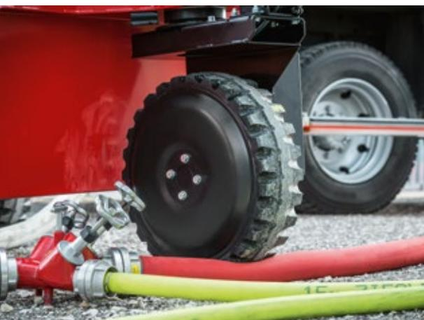
Innenliegendes Antriebssystem. Antriebsrad mit intelligenter Radprofilierung. Emissionsfrei und mit Motorbremse mit Sofort-Stop-Funktion.
