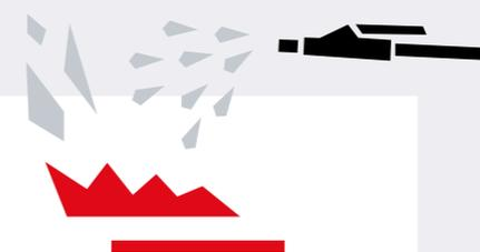
Löschen Sie den Brand bis keine Flamme und kein Rauch mehr zu sehen ist. Die Löschkraft liegt zwischen 10 und 30 Sekunden – je nach Größe des Feuerlöschers.
