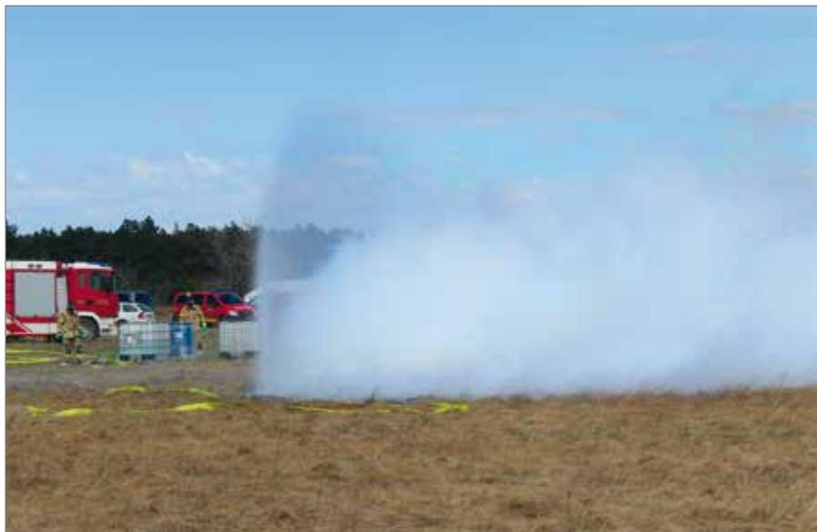
Abbildung 7: Reaktion von Chlor mit Ammoniumhydroxidlösung bei der Aufbringung über ein Hydroschild
