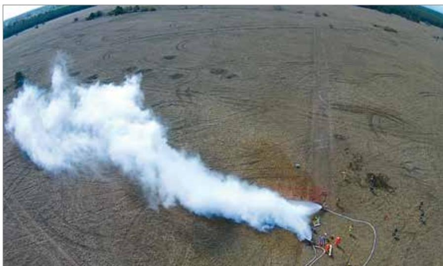
Abbildung 8: Reaktion von Chlor mit Ammoniumhydroxid bei der Aufbringung durch Wasserwerfer (je 1200 l/min)
