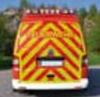
Original design112 Heck-Warnmarkierungssätze fertig angepasst und spannungsfrei zur leichten Selbstmontage. Mit abgerundeten Ecken und ohne Stoßkanten auf den Flächen, für minimale Angriffsfläche und maximale Lebensdauer.
