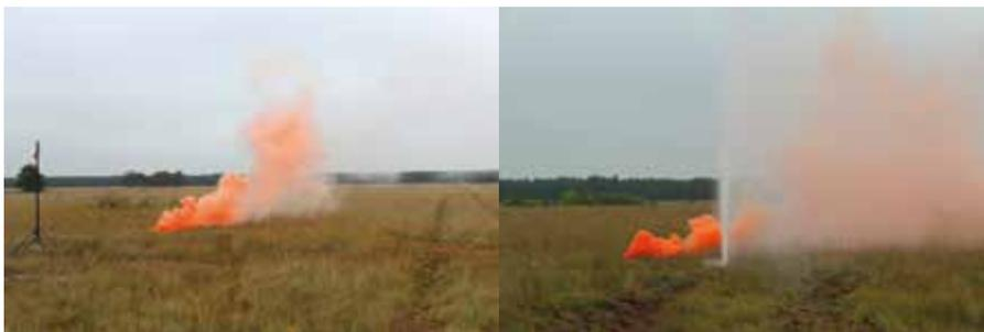
Abbildung 4: Einsatz von Tracer Partikeln zur Darstellung des Durchbrechens von schwerlöslichen Gasen beim Hydroschild
