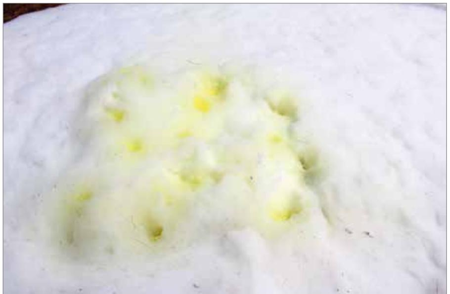
Abbildung 10: Mittelschaumdecke aus Synth. Mehrbereichsschaummittel, 8 min nach Aufbringen auf eine Chlor Lache
