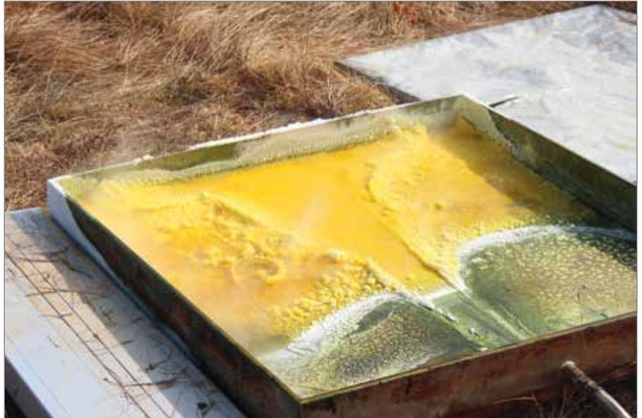
Abbildung 9: Bildung von Chlorhydrat durch die Reaktion von Chlor mit Wasser
