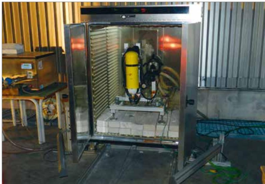
Bild 1: Mit Thermoelementen instrumentiertes Versuchsobjekt im Wärmeschrank [Neske und Starke 2014]
