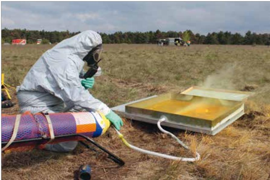
Abbildung 3: Freisetzen von flüssigem Chlor mittels beheizbarer Metallwanne
