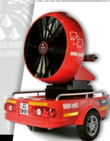
Der Großlüfter EASY 4000 ist der leistungsfähigste Lüfter des Lüfterangebots von Leader. Mit seiner Luftleistung von 410.000 m<sup>3</sup>/h ermöglicht er die Entrauchung und Kühlung sehr großer Räume (Tunnel, Industriegebäude, Flughafenhallen usw.). Der EASY 4000 verfügt über einen BMW-Motor mit Direktantrieb zwischen dem Motor und dem Lüfterrad (keine Kraftübertragungsriemen).
