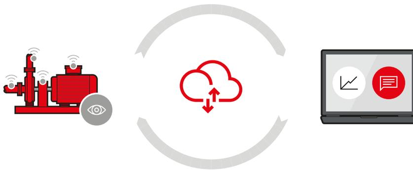
Um die wöchentlichen Pumpenstarts automatisiert durchführen zu können, werden zusätzliche Sensoren, zum Beispiel für Drücke, Temperaturen oder Vibration, und ein **Automatic Inspection and Testing Controller (AITC)** in der Anlage installiert. Der AITC tauscht Informationen mit dem **Elektronischen Sprinklerschalterschrank (ESS5000)** aus, sammelt Signale und leitet sie an eine Cloud weiter.
