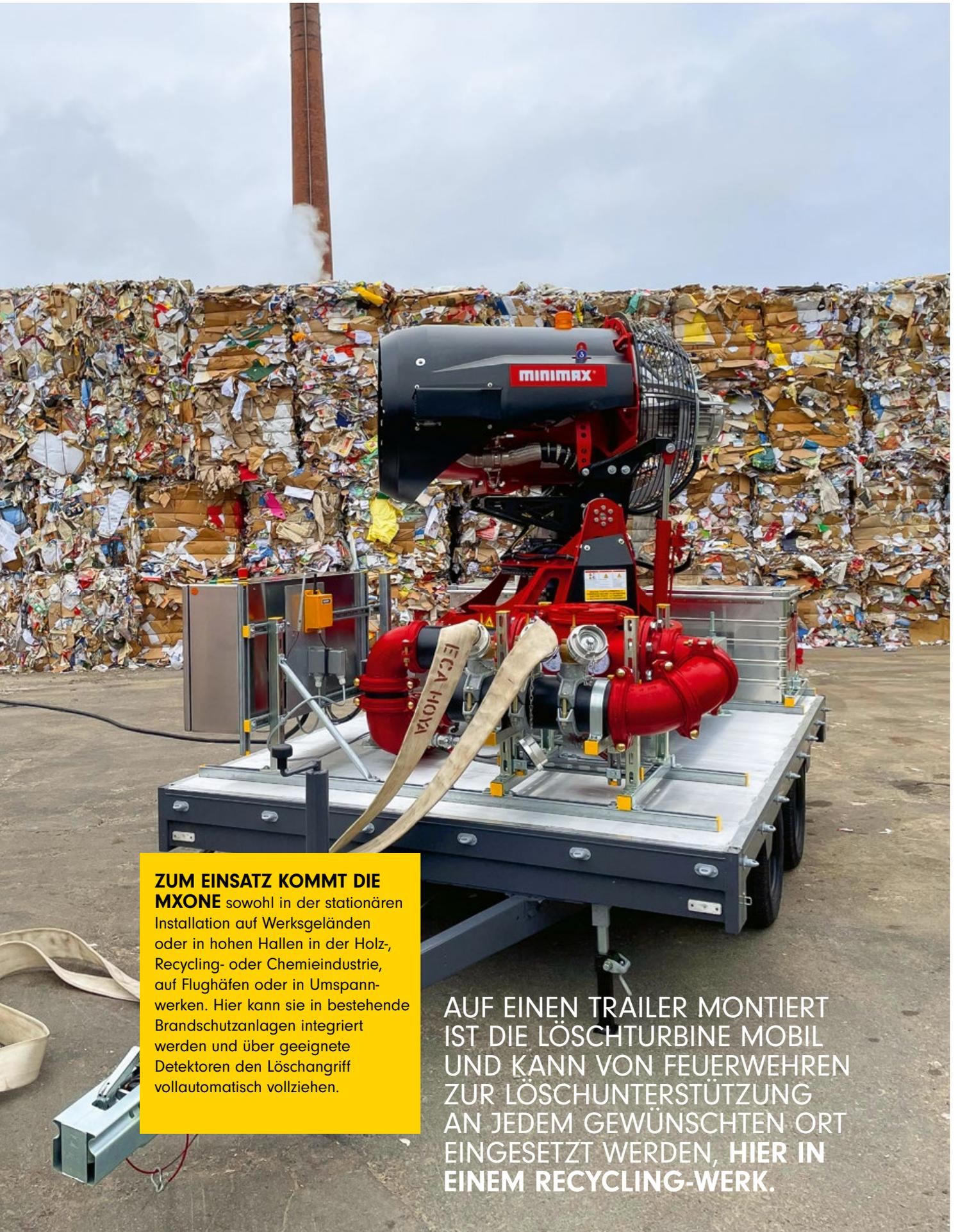
**ZUM EINSATZ KOMMT DIE MXONE** sowohl in der stationären Installation auf Werksgeländen oder in hohen Hallen in der Holz-, Recycling- oder Chemieindustrie, auf Flughäfen oder in Umspannwerken. Hier kann sie in bestehende Brandschutzanlagen integriert werden und über geeignete Detektoren den Löschangriff vollautomatisch vollziehen.
