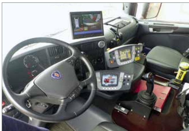
Der Arbeitsplatz des Maschinisten ist um eine Vielzahl von Bedienelementen erweitert, die es erlauben, das Fahrzeug sicher zu bewegen und einzusetzen.
