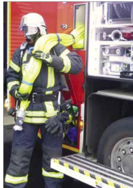
Taktisch berücksichtigt wurde der Einsatz von 45 m langen Schlauchpaketen, die beidseitig in einer ergonomischen Entnahmehöhe für den Trupp verbaut wurden.
