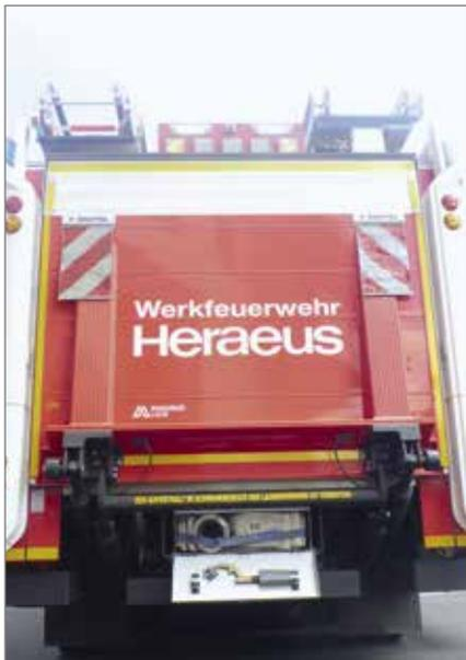
Unterhalb der Ladebordwand sind die in Buchten gelegten A-Druckschläuche zur schnellen Entnahme zu erkennen.
