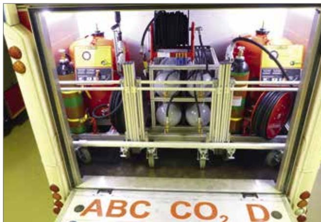
Die geöffnete Ladebordwand mit den Rollcontainern für die Sonderlöschmittel CO<sub>2</sub> und ABC- und D-Pulver. Die Bedieneinheiten der Löschcontainer lassen einen sofortigen Einsatz zu.
