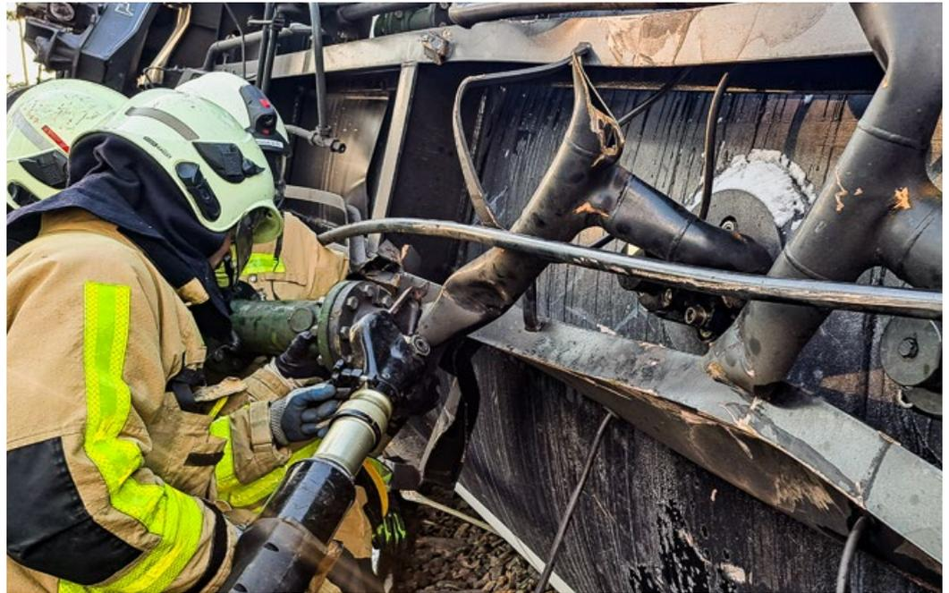
**Kraftakt: Die Einsatzkräfte demontierten die stark beschädigten und deformierten Auslaufarmaturen an einem der Kesselwagen, um dann eine Neuinstallation vorzunehmen.**
