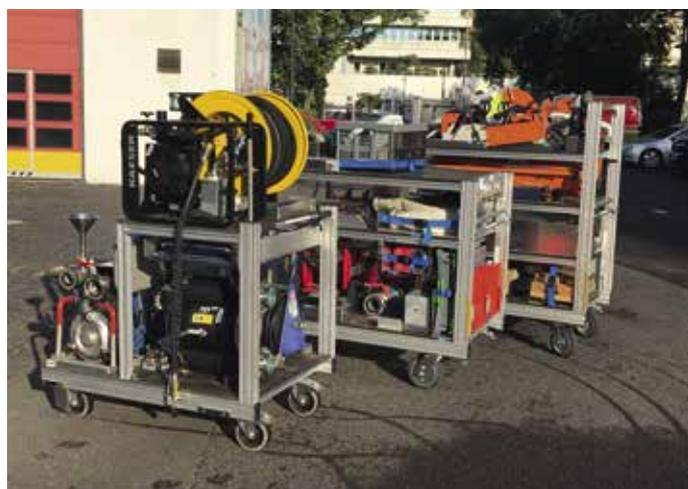
Abb. 4: Drei der Rollwagen, v.l.n.r.: Gefahrgutpumpen, Dienstleistung, technische Hilfeleistung.
