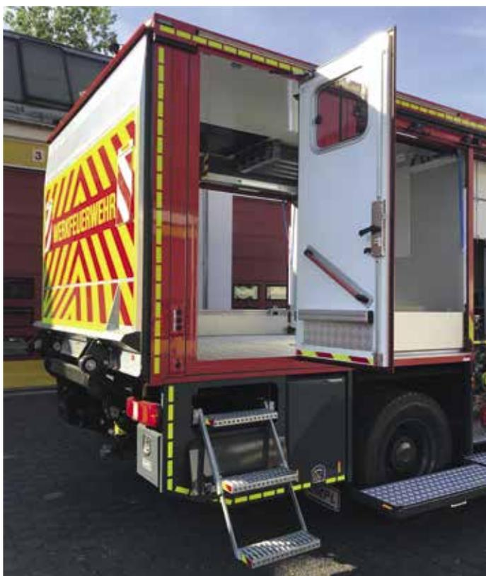
Abb. 3: Der Logistikbereich verfügt über Platz für bis zu 6 Rollwagen oder Europaletten und ist zusätzlich zur Ladebordwand auch von der Seite begehbar.
