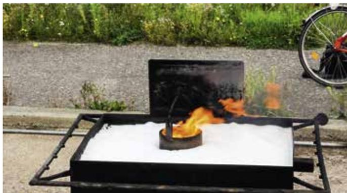
Abb. 1: Rückbrandtest zur Überprüfung der Schaumqualität
