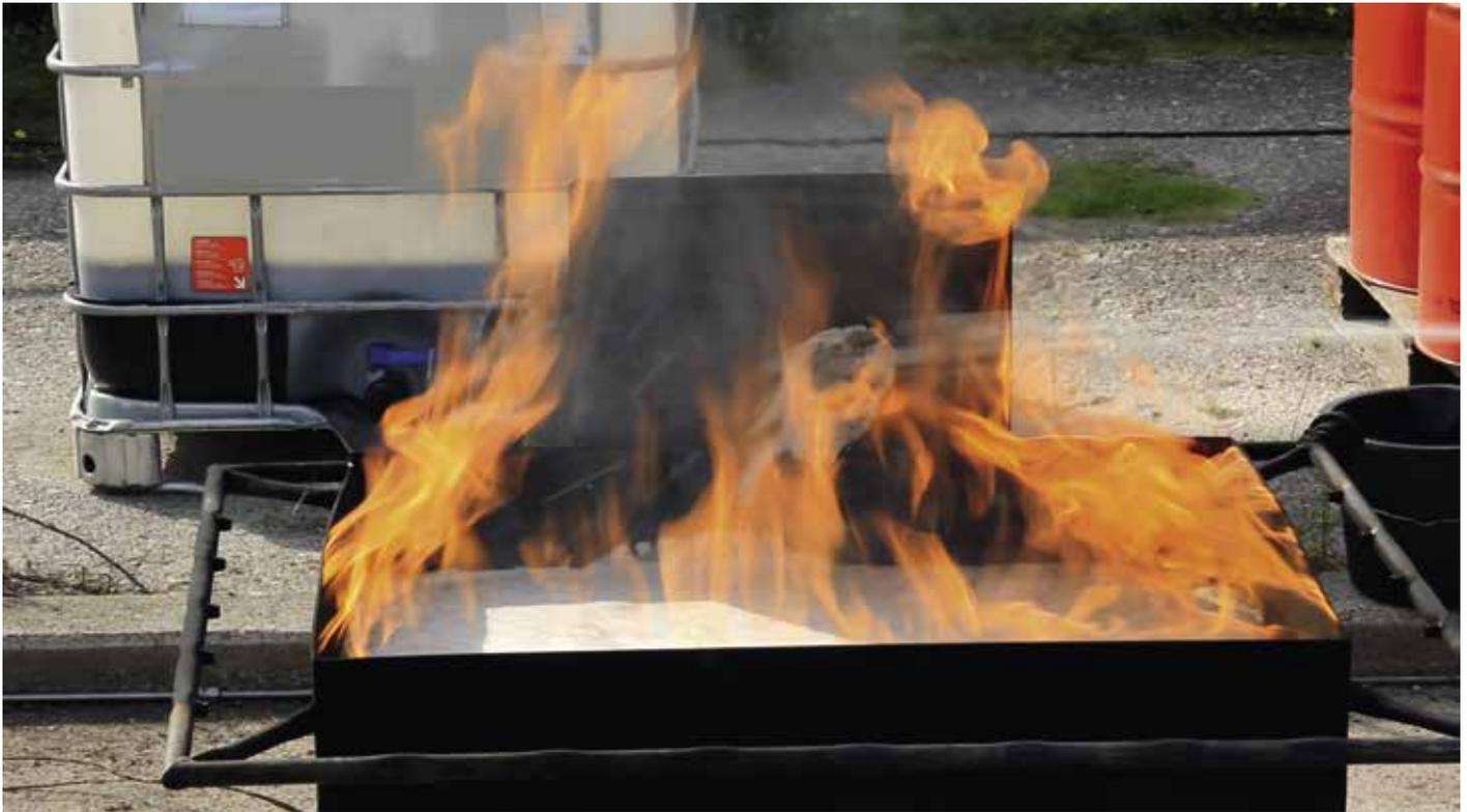
Abb. 2: Löschtest zur Überprüfung der Schaumqualität
