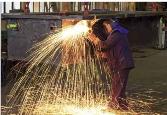
Arbeiter beim Brennschneiden in einer Fabrik
