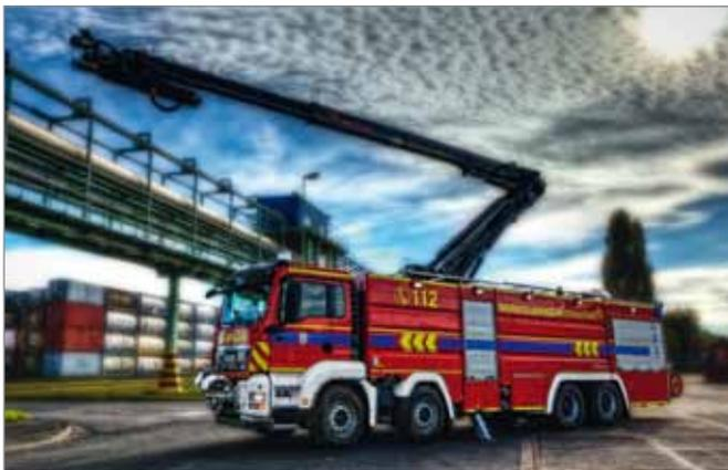
GTLF einer Werkfeuerwehr der chemischen Industrie. Die Besatzung besteht aus einem Maschinisten. Das Fahrzeug führt 12.000 l Wasser und 5.700 l Schaummittel mit. Die Pumpenleistung: 10.000 Liter pro Minute bei 10 bar. Der Löscharm mit Piercingtool ist 16,50 m lang.
