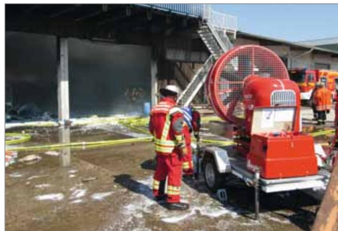
*Viele Werkfeuerwehren halten Spezialtechnik vor. Diese kommt bei Bedarf auch außerhalb des Unternehmens zum Einsatz. Hier ein Großlüfter der Werkfeuerwehr Bosch Schwieberdingen.*
