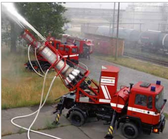
Die Vattenfall Europe Mining & Generation verfügt über zwei Abgaslöschfahrzeuge (AGLF). Diese erzeugen Wassermistwolken zur Brandbekämpfung oder zur Kühlung mittels Flugzeugtriebwerk (MIG 17). Dabei erfolgt die Aufnahme von bis zu 7.000 l/min Löschmittel in den Abgasstrahl mit Reichweiten von 120 bis 150 m (horizontal) und 25 bis 40 m (vertikal).
